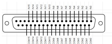
На схеме приведена схема разъема для 16 каналов вывода. Устройство содержит 4 разъема с аналогичной схемой подключения контактов. Назначение контактов определяется программно.
